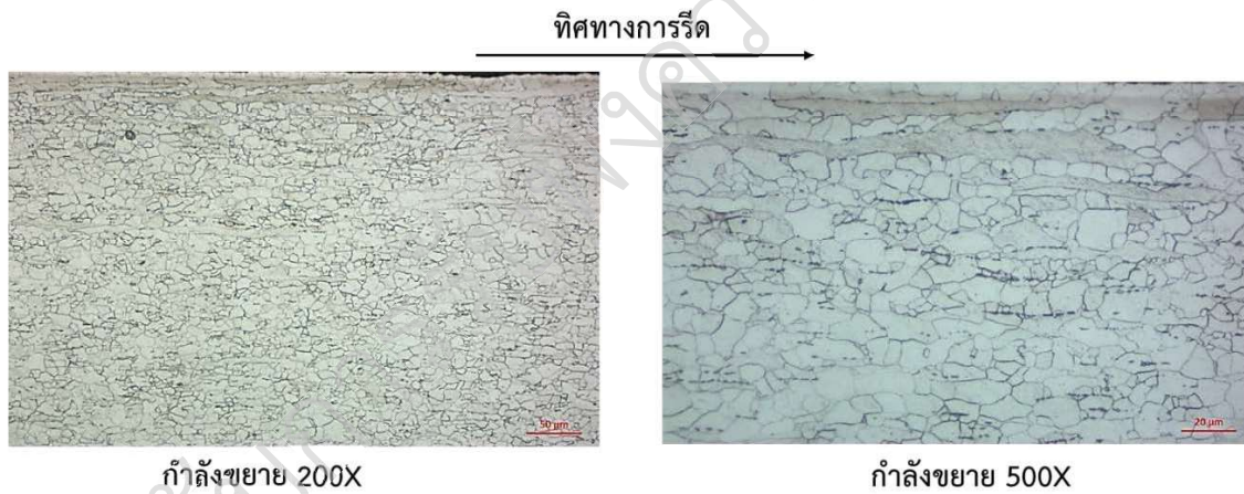
รูปที่ ก.6 รูปถ่ายโครงสร้างจุลภาคของเหล็กแผ่นรีดเย็น
