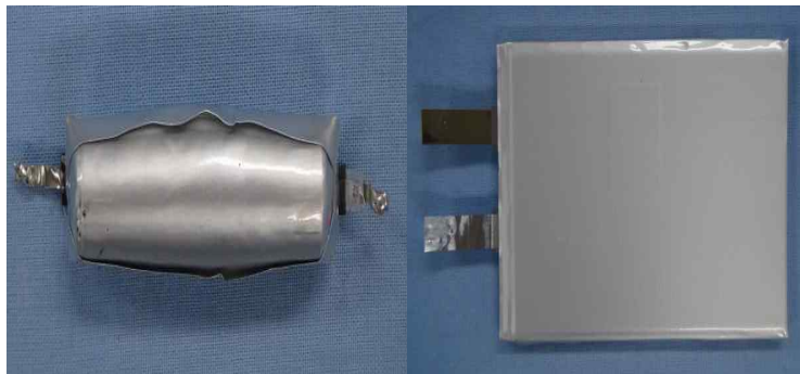
그림 D.1 — 소프트 케이스 재질을 갖는 단전지
