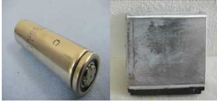
그림 D.2 — 하드 케이스 재질을 갖는 단전지
